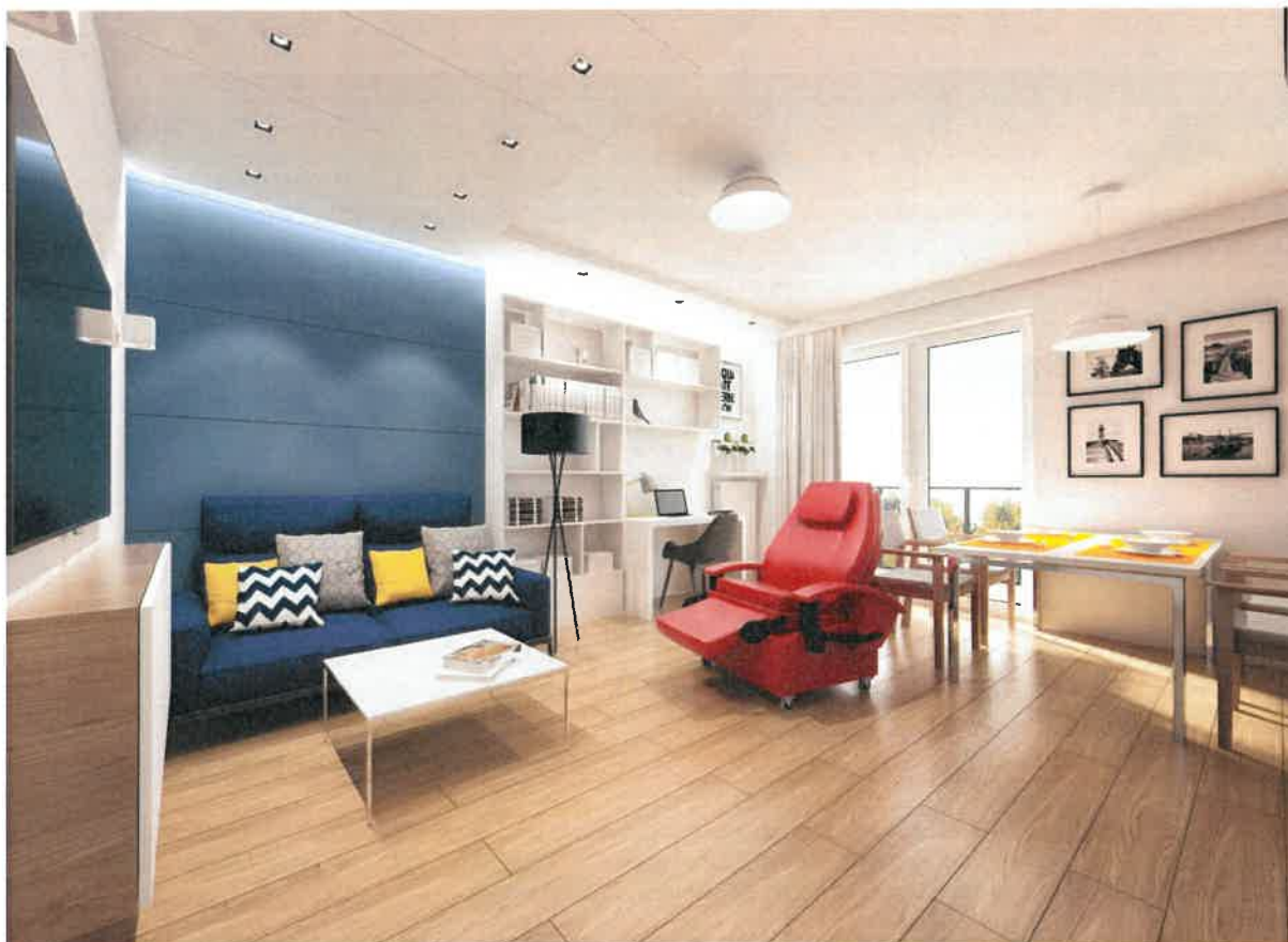
Fot. Pokój dzienny – na ścianie zastosowano panele ściennie Acusto One (Ecophone), na suficie panele akustyczne Solo (Ecophone). Fotel pionizujący (TON). Źródło: „Wytoczne w zakresie projektowania uniwersalnego mając na uwadze potrzeby osób niepełnosprawnych”, Warszawa 2016 – ekspertyza wykonana przez Fundację Laboratorium Architektury 60+ na zlecenie Ministerstwa Infrastruktury i Budownictwa.
